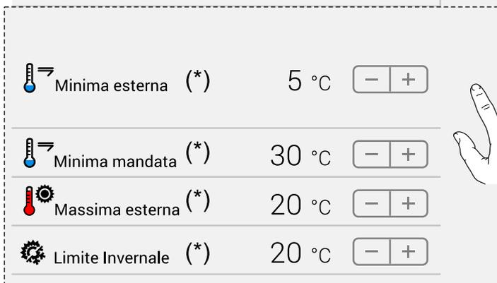
График внешней компенсации - T макс. 70°C - T наруж. от 5°C до 20°C - T мин. 30°C
